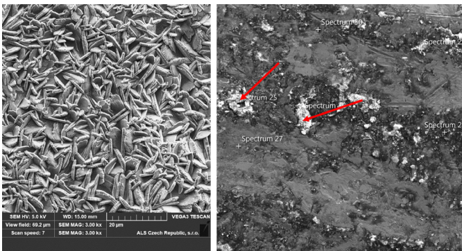
Kuva 2. (A) korroosionestokerros; (B) korroosiojälkiä
